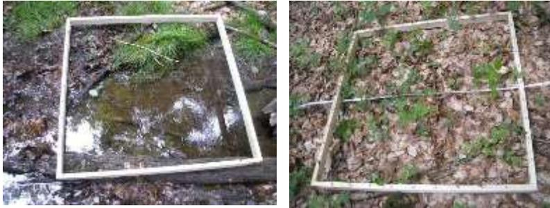
**Abb. 8:** Aufnahme der Bach- und Umgebungsparameter mittels des Messquadrats. *Bild A:* Erfassung der abgedeckten Bachfläche und der verschiedenen Bedeckungsgrade der Bachparameter. *Bild B:* Erfassung der Umgebungsparameter hier am Beispiel der Krautschichtbedeckung in 1 m<sup>2</sup>.
